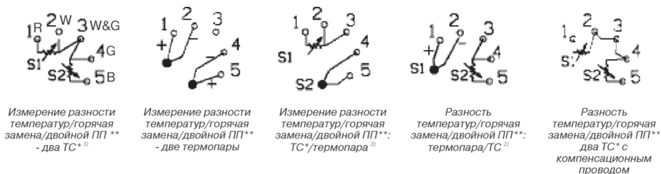
Рис.10. Схема подключения двойного первичного преобразователя к Rosemount 3144P-Foundation fieldbus.
