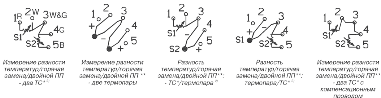
Рис.8. Схема подключения двойного первичного преобразователя к Rosemount 3144P-HART/4-20 мА.
