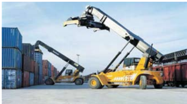
Рисчтакеры, работающие на железнодорожном фронте контейнерного терминала. При подъеме (отрыве) контейнера от поверхности создается давление до 110 т на переднюю ось
